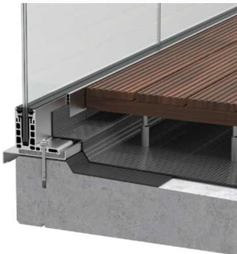
(A) Außenanwendung: Beispiel Balkon mit Betonelementen, Gefälle nach innen exterior application: example balcony with concrete elements, slope inwards
