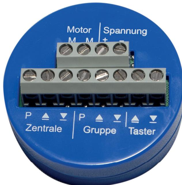
Wird über den Einzelschalttereingang bedient und im selben Moment erfolgt über Zentrale ein Gegenbefehl, so werden über eine spezielle Elektronik die Relais verzögert umgeschaltet, um ein Verkleben der Relais wie bei herkömmlichen Steuereinheiten zu verhindern.
