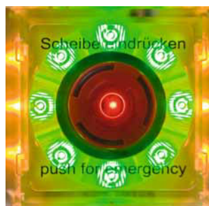
Türzustand: Freischaltung/Notentriegelung, grün/gelb blinkend
