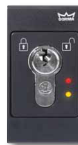
Schlüsseltaster TL-Profil mit LED-Zustandsanzeige Türzustand: Sabotageversuch, rot/gelb blinkend
