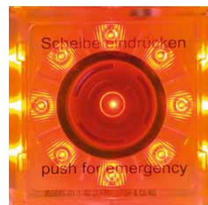
Türzustand: Sabotageversuch, rot/gelb blinkend
